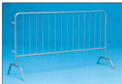
TRANSENNA PEDONALE Zincata, in tubo diametro mm 33 e tondino diametro mm 12, lunghezza m. 2, altezza cm 110. Munita di ganci collegati tra loro in linea o ad angolo. art. TS200 Transenna pedonale
