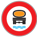
Mod. 64/b TRANSITO VIETATO AI VEICOLI CHE TRASPORTANO PRODOTTI SUSCETTIBILI DI CONTAMINARE L'ACQUA
