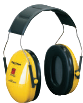
OPTIME I - SNR:27 H:32 M:25 L:15 AO/H510A - Bard.temporale, SNR:27 dB AO/H510B - Bard.nucale, SNR:26 dB AO/H510F - Bard.pieghevole, SNR:28 dB AO/H510P3 - Per elmetti Peltor, SNR: 26 dB
