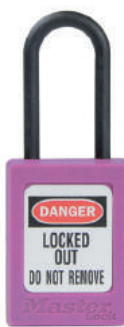
Modello LUS32 - corpo piccolo, amagnetico realizzato interamente in Zenex, archetto diametro mm. 4,76, lunghezza mm. 38
